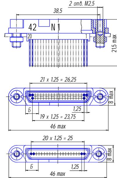
Розетка типа а – установка с внутренней стороны стенки прибора
