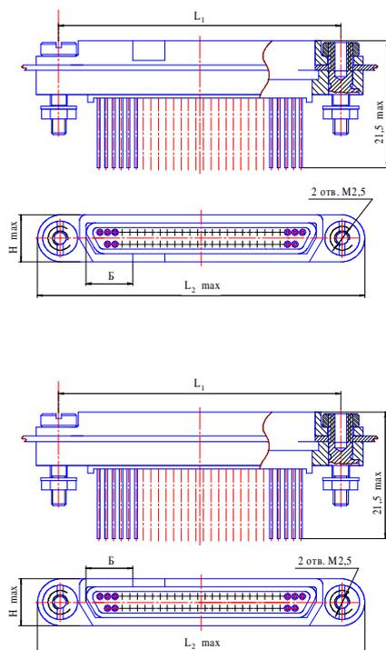
Розетка типа б – установка с наружной стороны стенки прибора
