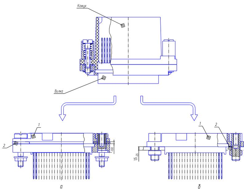
где: а – установка розетки с внутренней стороны стенки прибора;
