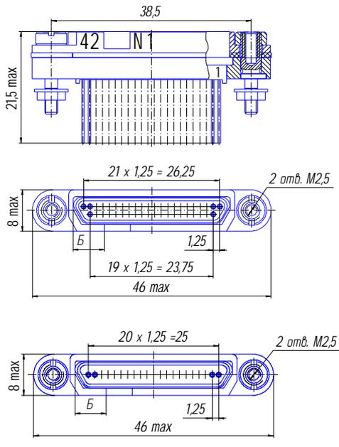
Розетка типа б – установка с наружной стороны стенки прибора
