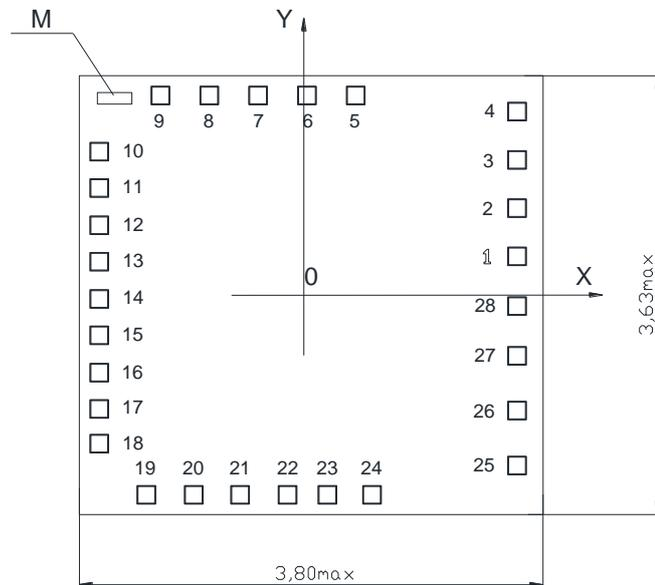
1. Номера контактных площадок (КП) присвоены условно, кроме первой КП и их расположение соответствует топологическому чертежу.
