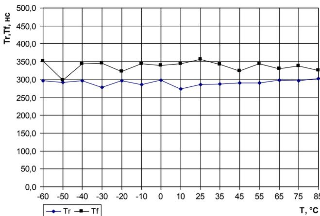
**Рис. 19** Зависимость времени нарастания/спада сигнала от температуры ( $U_{CC}=5,5$  В,  $C_H=150$  пФ,  $R_H=7$  кОм)
