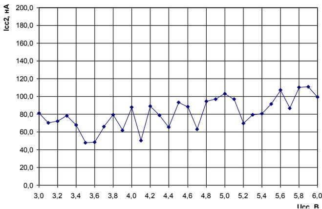
Рис. 5 Зависимость тока потребления в состоянии "Выключено" от напряжения источника питания
