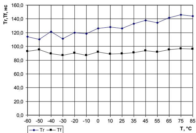
**Рис. 21** Зависимость времени нарастания/спада сигнала от температуры ( $U_{cc}=4,5$  В,  $C_n=1000$  пФ,  $R_n=3$  кОм, режим МВАUD)
