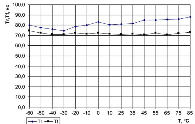
**Рис. 20** Зависимость времени нарастания/спада сигнала от температуры ( $U_{CC}=3,0$  В,  $C_H=250$  пФ,  $R_H=3$  кОм, режим MBAUD)
