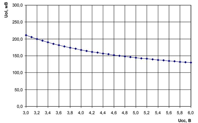
Рис. 6 Зависимость выходного напряжения низкого уровня приемника от напряжения источника питания
