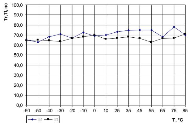
**Рис. 22** Зависимость времени нарастания/спада сигнала от температуры ( $U_{cc}=5,5$  В,  $C_n=150$  пФ,  $R_n=7$  кОм, режим МВАUD)
