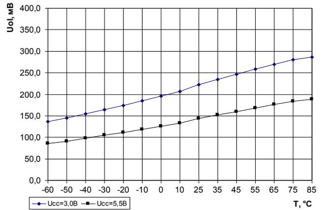
**Рис. 10** Зависимость выходного напряжения низкого уровня приемника от температуры
