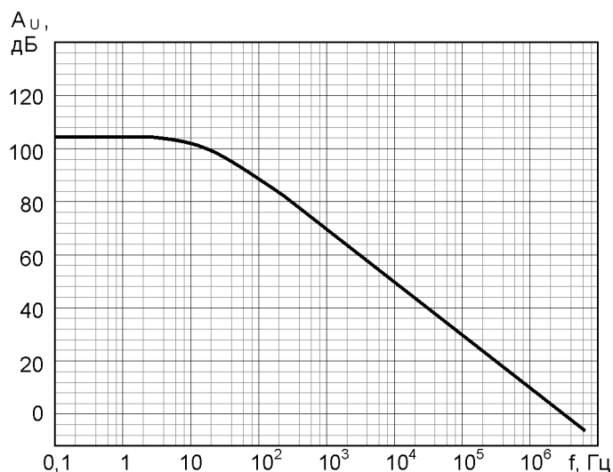
Типовая зависимость коэффициента усиления от частоты
